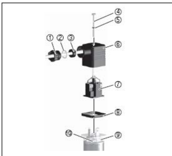
Рис. 7: подсоединение вентильного штекера DIN 43650
